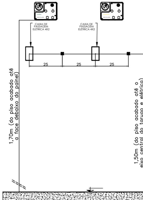
DETALHE PARA TARUGO DO PAINEL DE ALARME
